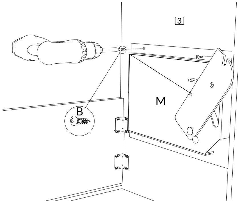
Insérer 11 vis de 5/8" (B) pour fixer le premier mécanisme au panneau #3.
