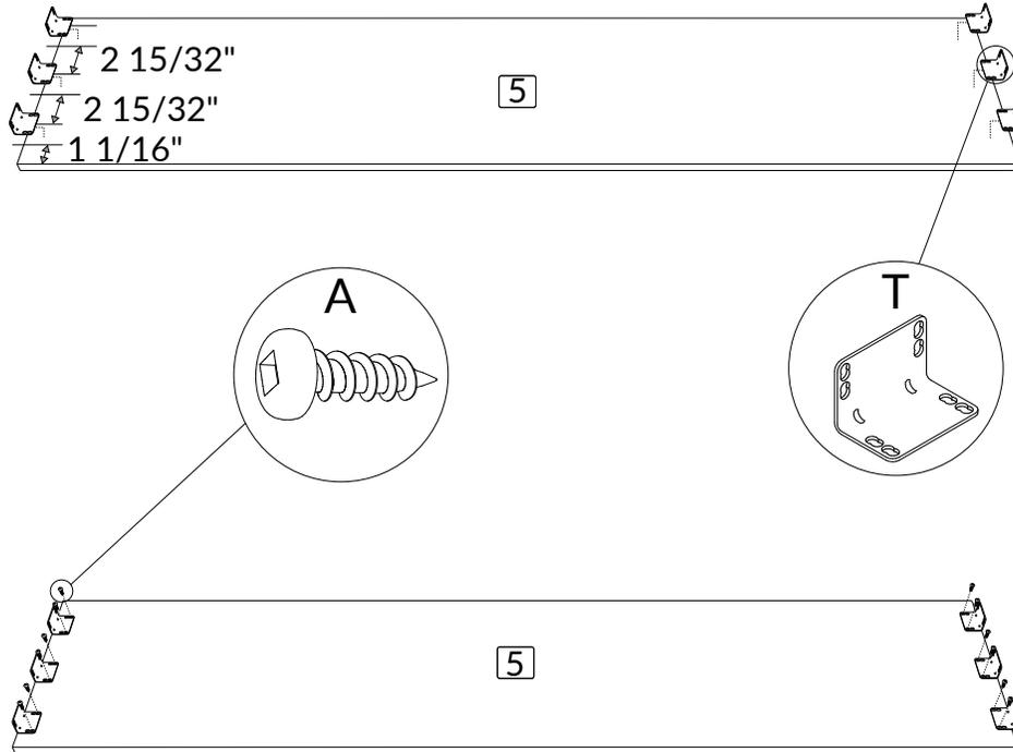
En suivant les mesures affichées, placer 4 renforts d'angle (T) sur le panneau #6.
