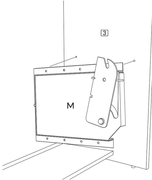
Insérer 2 vis de 5/8" (B) pour visser le premier mécanisme avec le panneau #3.
