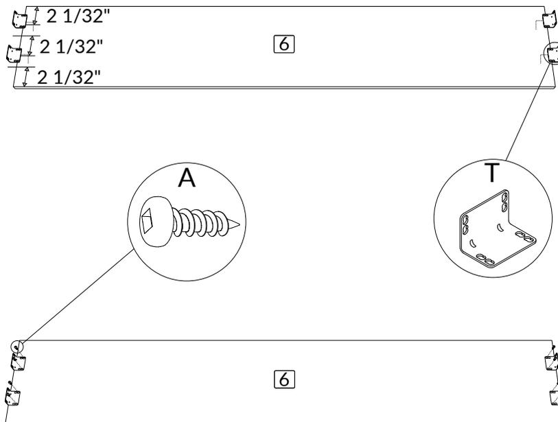
En suivant les mesures affichées, placer 6 renforts d'angle (T) sur le panneau #6A.
