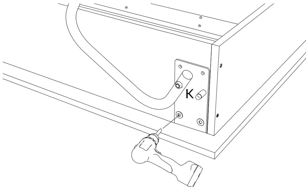
Insérer 2 boulons de 1 1/4" (E) pour fixer la patte du lit dans le panneau #12.
