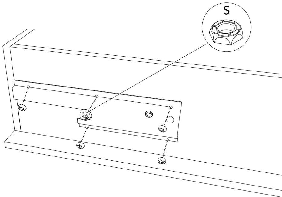
Installer les 2 panneaux #15 sur les cotés des panneaux #12 en haut des renforts d'angle.
