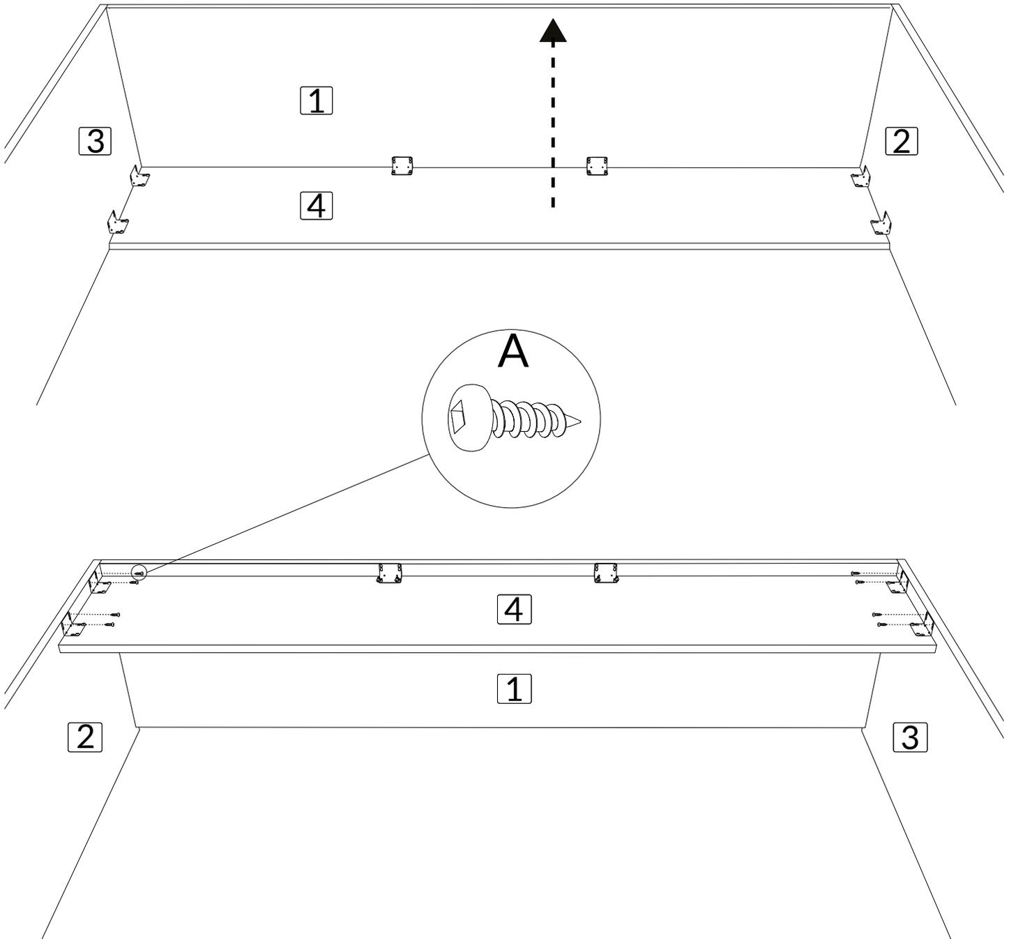
En suivant les mesures affichées, déplacer le panneau #5 vers le haut entre les panneaux #2 et #3.
