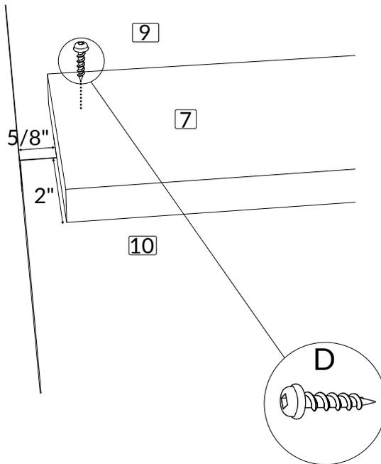
Fixer les panneaux #7 aux panneaux #8, #9, #10 et #11 avec 12 vis de 1 1/8" (D).
