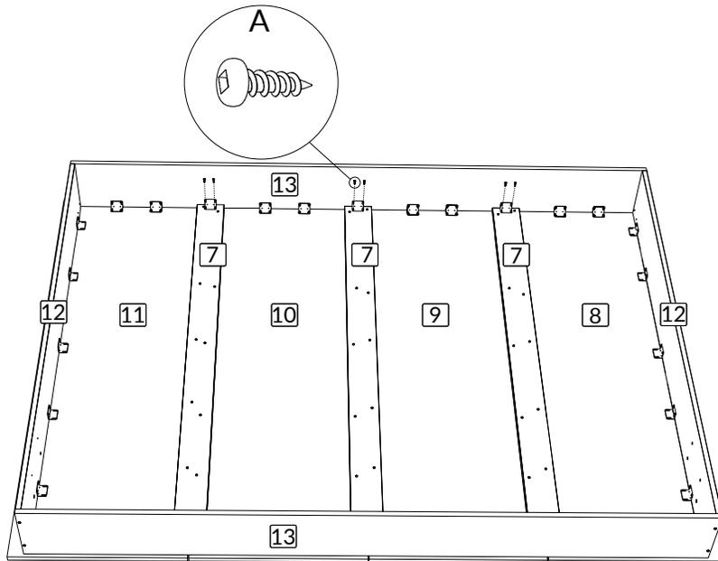
Insérer 20 vis de 9/16" (A) pour fixer les renforts d'angle dans les 2 panneaux #12.
