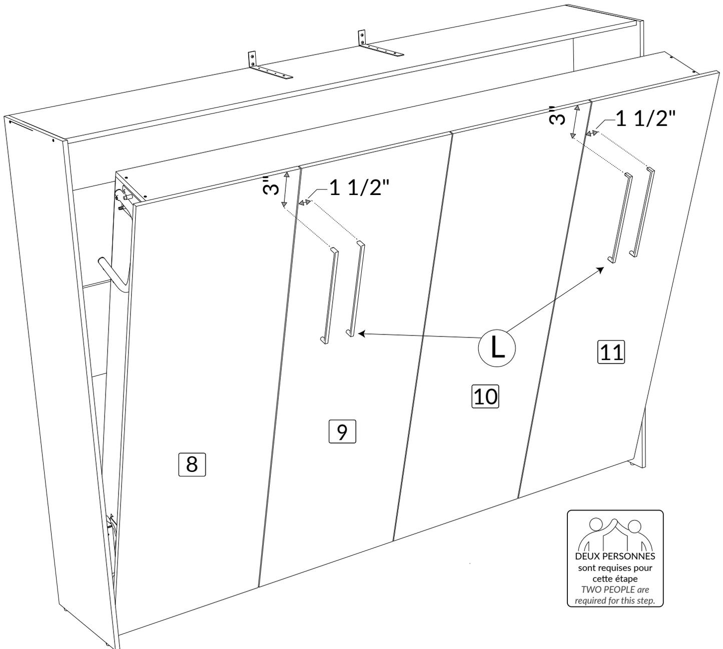
Insérer 8 vis de 1 1/2" (F) pour fixer les poignées aux panneaux #8, #9, #10 et #11.
