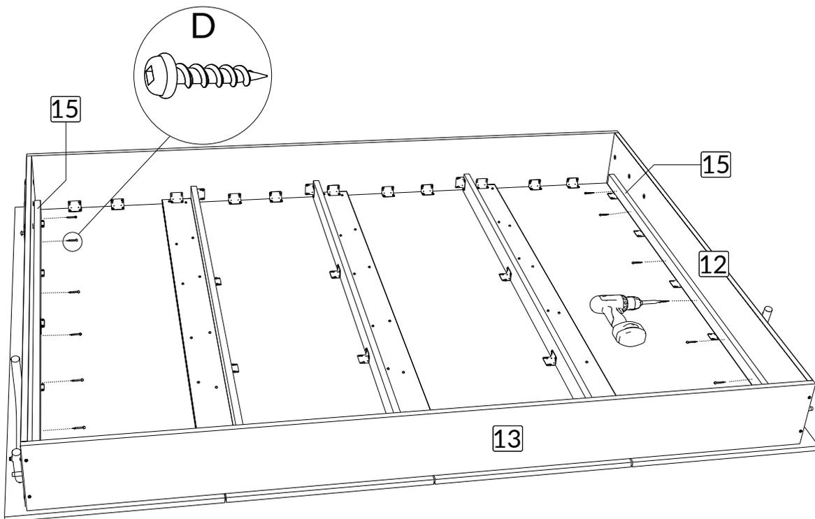
Soulevez les parties assemblées et glissez la base du lit jusqu'au fond de la rainure du mécanisme.
