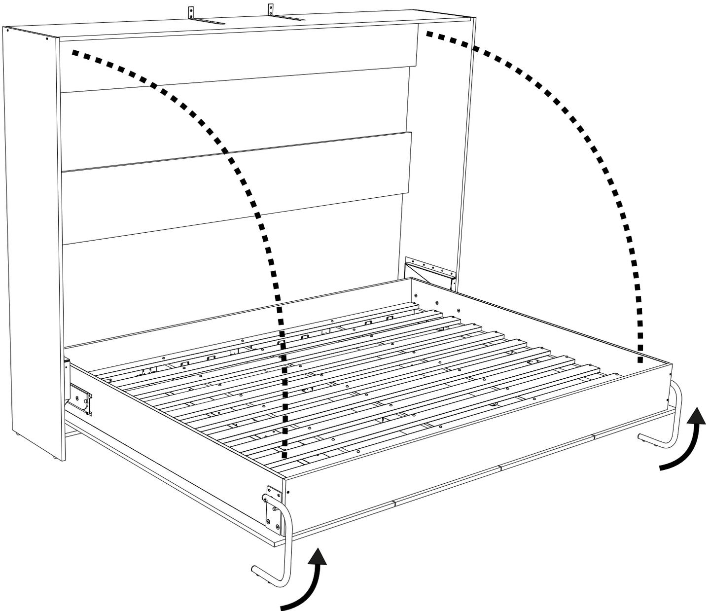
Visser les 6 vis de 5/8" (B) pour attacher définitivement les équerres murales avec le cadre du lit et avec le mur.
