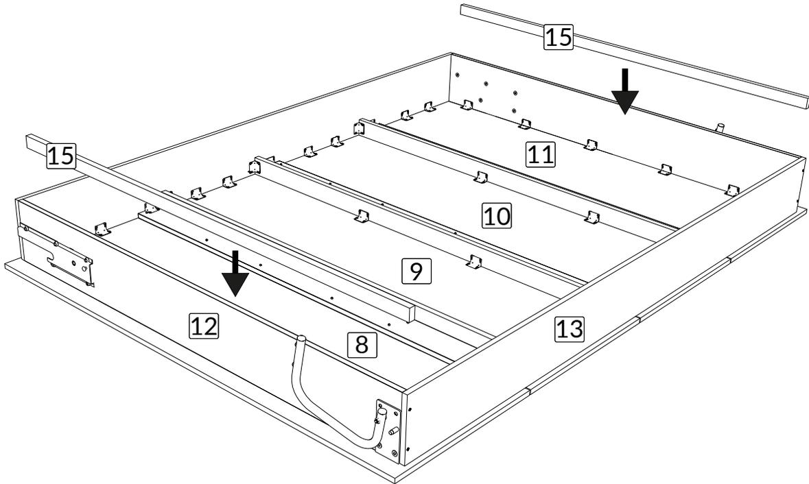
Insérer 12 vis de 1 1/8" (D) pour visser les 2 panneaux #15 avec les panneaux #12.
