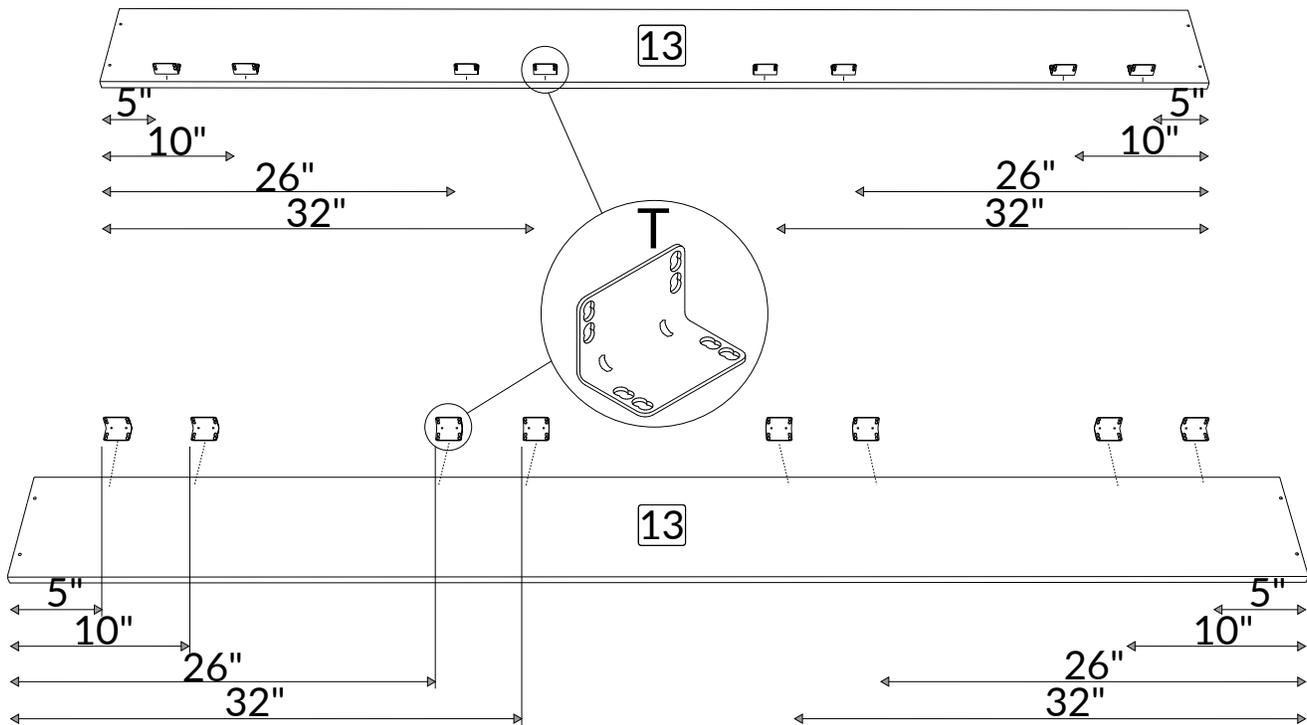
Insérer 32 vis de 9/16" (A) pour fixer les renforts d'angles dans les 2 panneaux #13.
