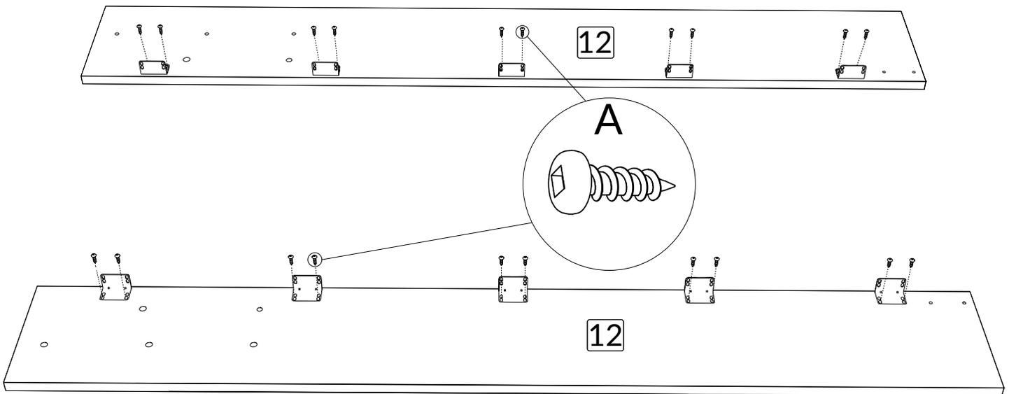
Positionner la tête et pied de lit #13 et les côtés de lit #12 ensemble, ensuite positionner les panneaux de porte #8, #9, #10 et #11 et les pièces de jointage #7 déjà assemblées en dessous comme indiqué.
