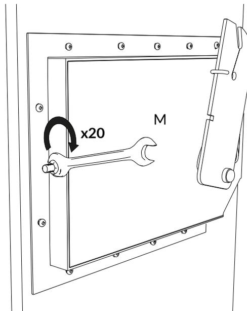
Répéter les mêmes étapes pour installer le 2e mécanisme (M) sur le panneau #2.
