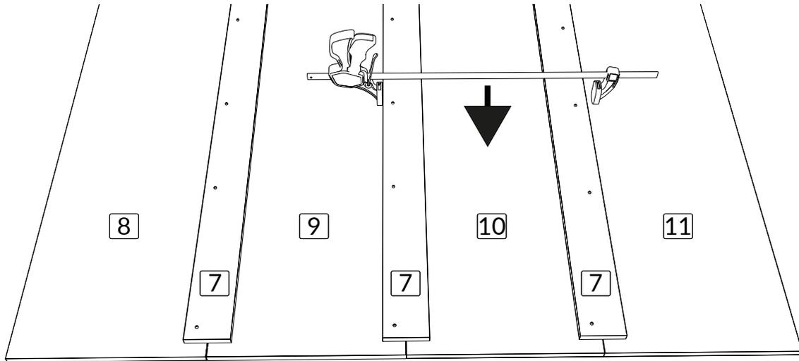
Insérer 6 vis de 1 1/8" (D) pour fixer les panneaux #7 dans les panneaux #8, #9, #10 et #11.
