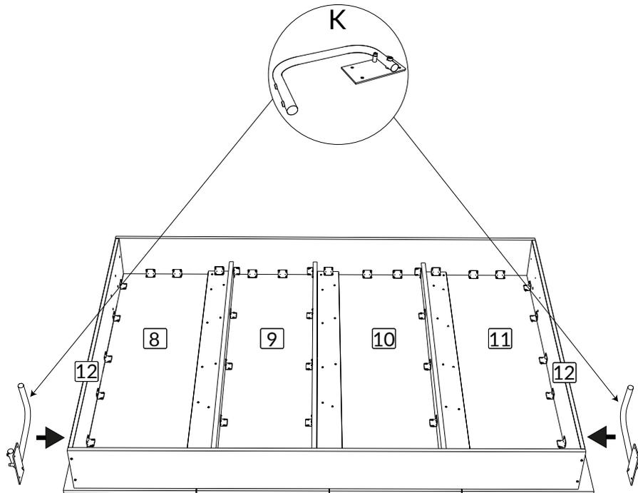
Si vous avez acheté un lit en boîte, les trous sont pré-perçés. Si vous avez acheté seulement le mécanisme, utiliser une perceuse avec une mèche de 1/4" pour percer les deux trous du bas en tenant fermement les pattes.
