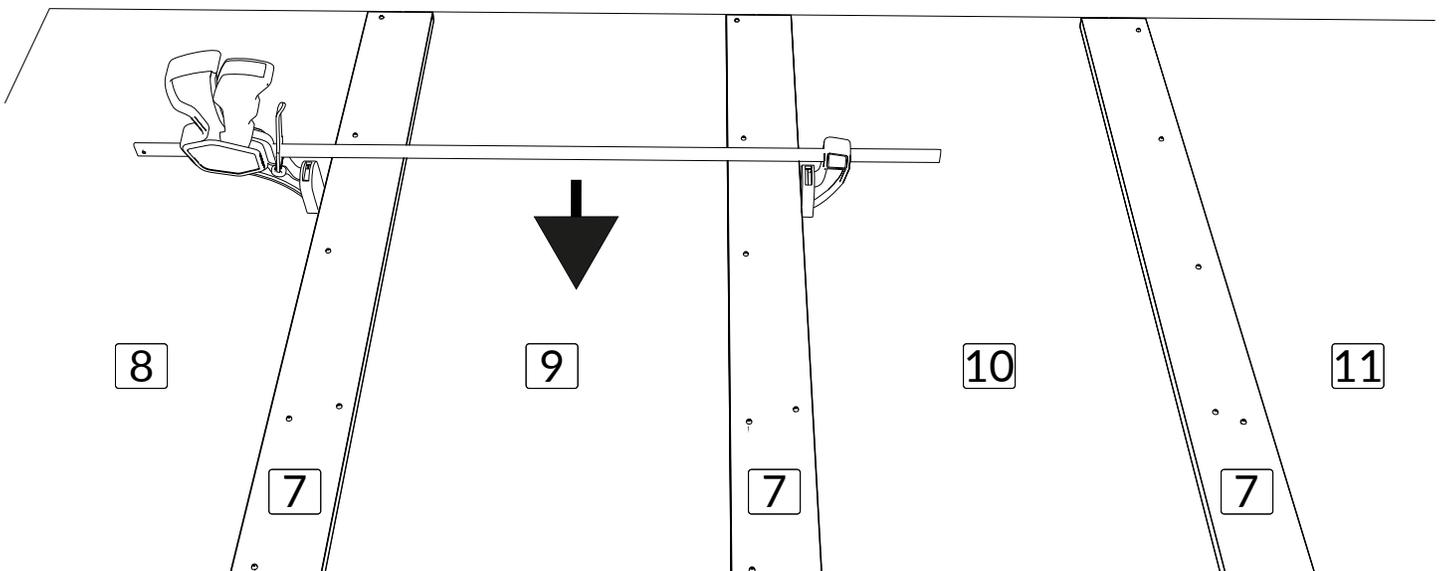
Insérer 4 vis de 1 1/8" (D) pour fixer les panneaux #7 sur les panneaux #8, #9, #10 et #11.
