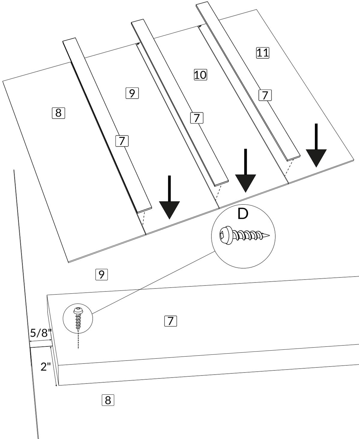
Insérer 3 vis de 1 1/8" (D) pour fixer les panneaux #7 dans les panneaux #8, #9, #10 et #11.
