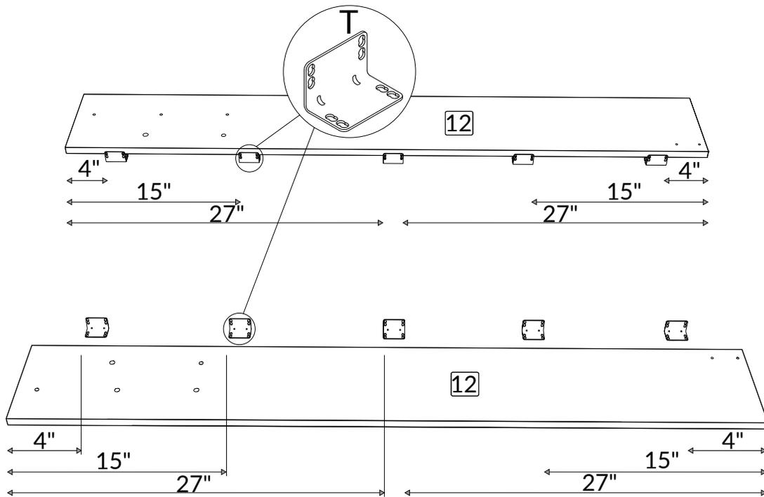
Insérer 20 vis de 9/16" (A) pour fixer les renforts d'angles dans les 2 panneaux #12.
