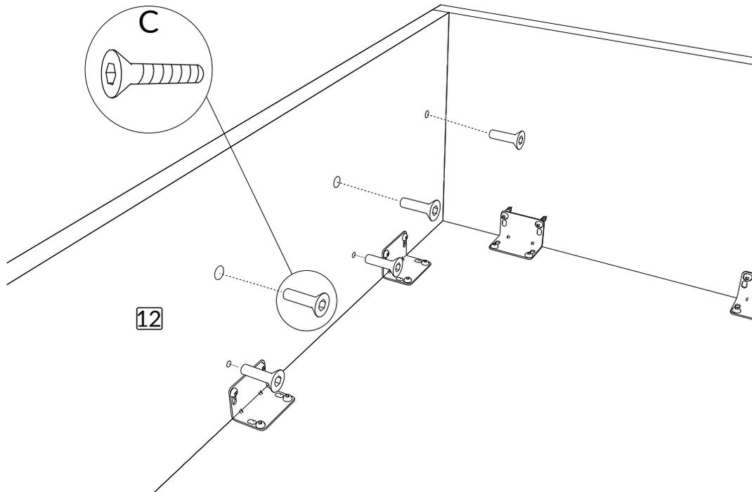
Insérer 5 écrous de 7/16" (S) pour attacher le support du mécanisme au panneau #12 et répéter la même procédure pour le deuxième support du mécanisme de l'autre côté.
