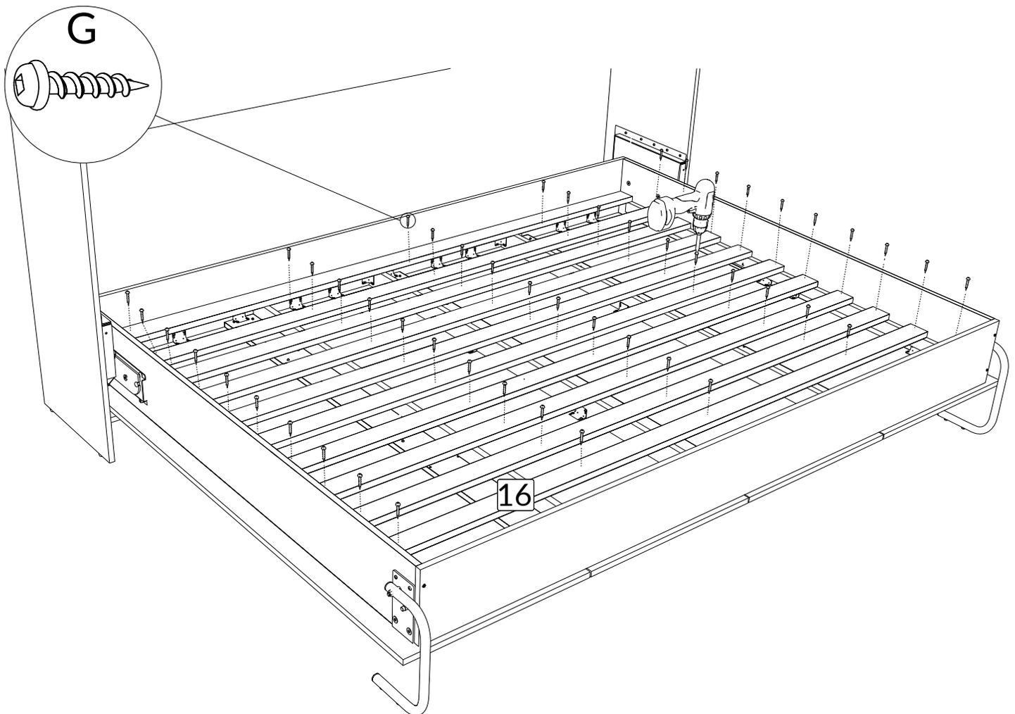
S'assurer que le cadre de lit et la base sont de niveau et les ajuster en conséquence si nécessaire avant de visser définitivement le cadre de lit au mur.
