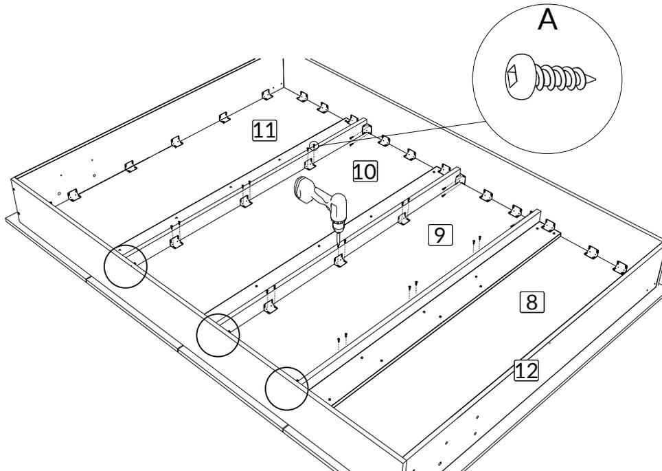
Insérer 30 vis de 9/16" (A) pour fixer les renforts d'angle dans les 3 panneaux #14.
