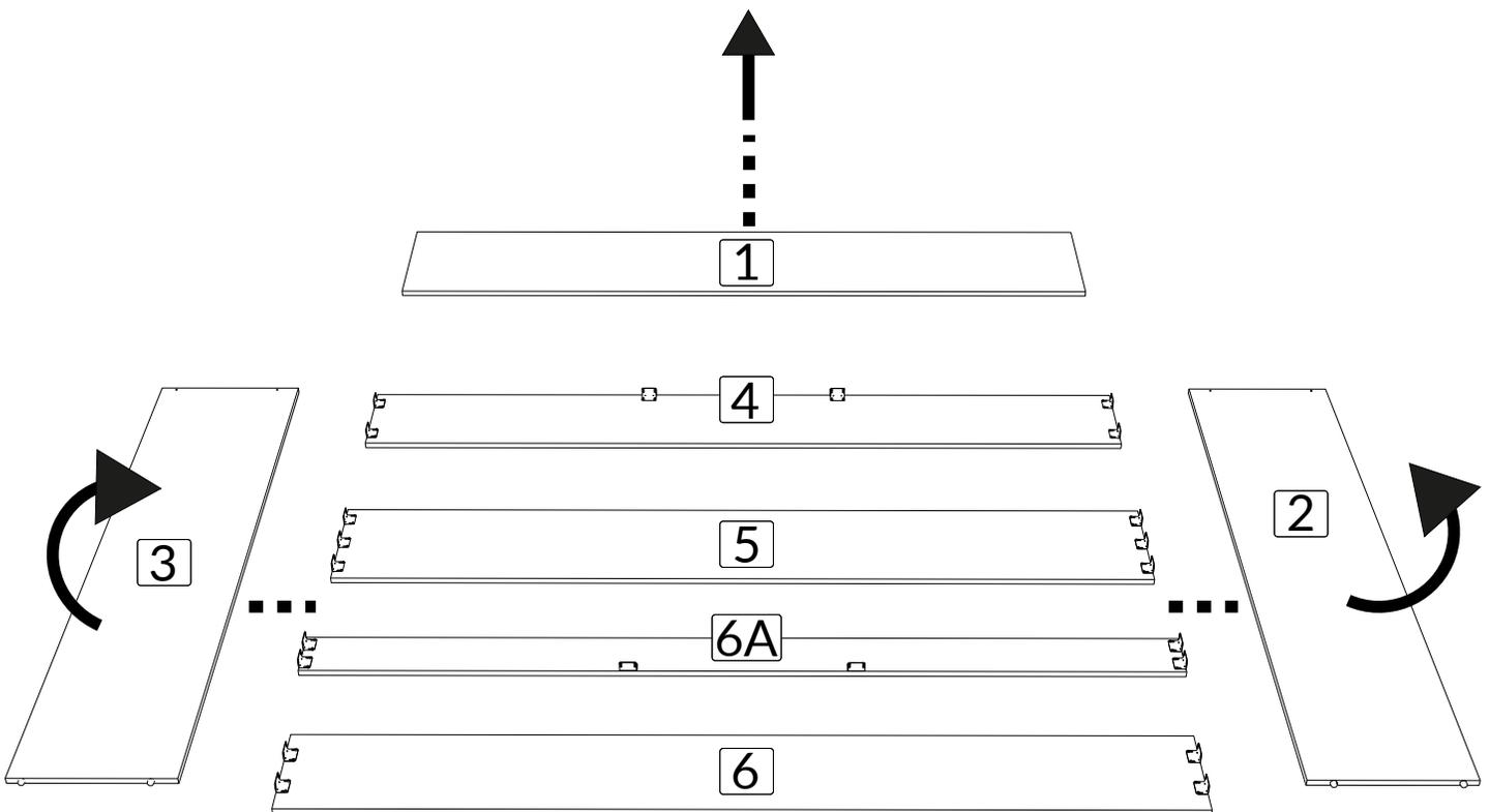
En suivant les mesures affichées, insérer 2 vis de 1 5/8" (I) pour attacher le panneau #1 au panneau #3.
