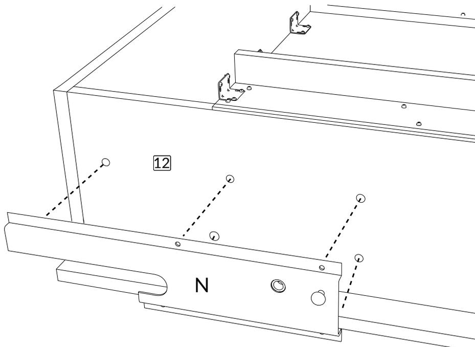
Insérer 5 boulons de 1" (C) pour fixer le support du mécanisme du lit au panneau #12.
