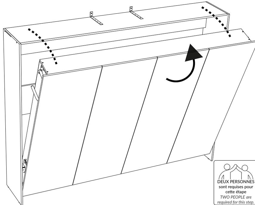
Ouvrir le lit, et baisser les pattes à mi-chemin pour que le lit se pose sur le sol.
