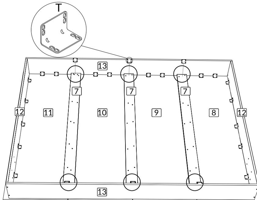
Insérer 12 vis de 9/16" (A) pour fixer les renforts d'angle dans les 3 panneaux #7.
