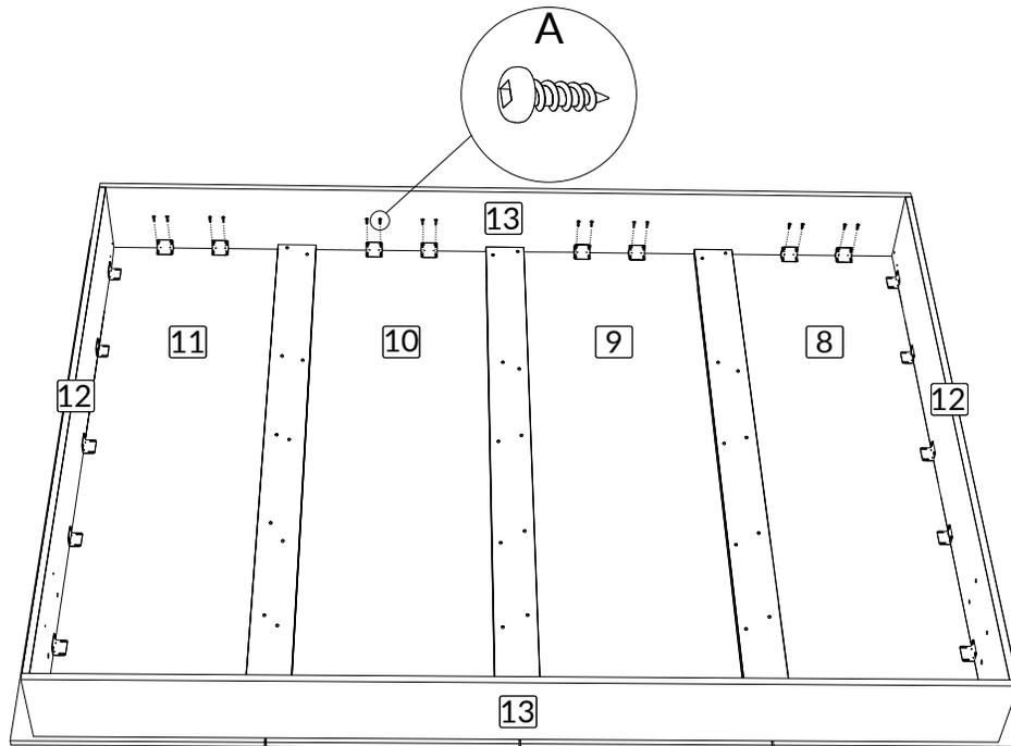
En suivant les mesures affichées, insérer 2 vis de 1 5/8" (I) pour fixer les 2 panneaux #12 avec les 2 panneaux #13.
