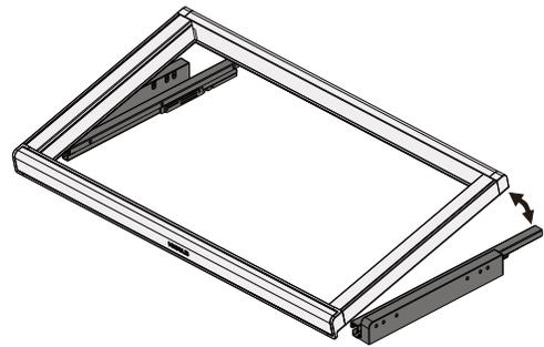
2.2 Accoter la partie arrière de l'avant du cadre sur l'avant des coulisses. Puis baisser l'arrière du cadre jusqu'à la fixation complète.
