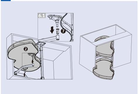
Insérer les fixations de tablette (7) dans les socles des mécanismes de support (3), puis y fixer les tablettes (2) tel qu'illustré.
