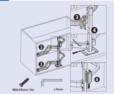
Installer les mécanismes de support de tablette (3) à l'aide des vis hexagonales tel qu'illustré.
