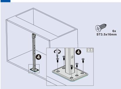
Insérer la partie supérieure du poteau (1) dans la partie inférieure (4), puis fixer le poteau au bas du caisson à l'aide des vis à bois incluses.
