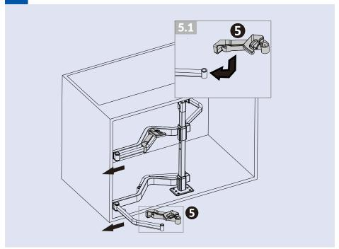
Fixer les amortisseurs (5) au mécanisme de support (3).
