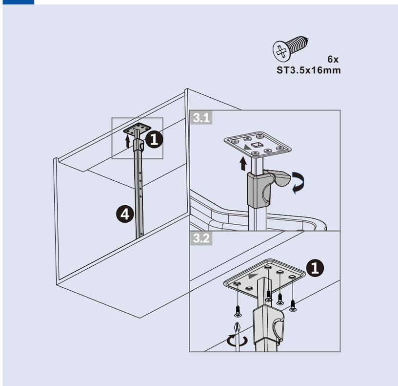
Régler le poteau à la hauteur désirée, puis verrouiller à l'aide de la poignée, puis le fixer ensuite au haut du caisson à l'aide des vis à bois.
