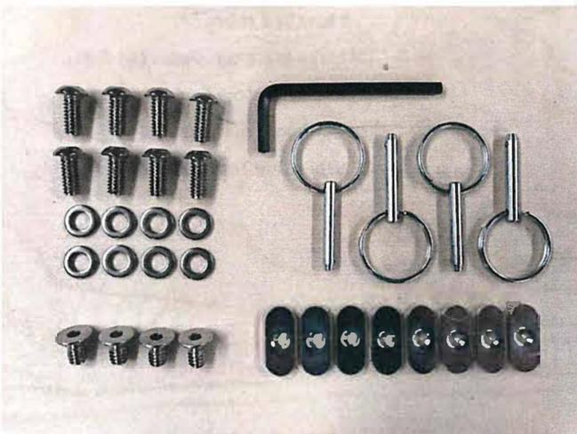
Ensemble de quincaillerie comprenant : clé Allen de 5/32", (8) vis à tête bombée de 1/4-20 x 9/16" et rondelles, (4) vis à tête plate de 1/4-20 x 7/16", (8) écrous plats et (4) goupilles annulaires de 3/16" de diamètre.
