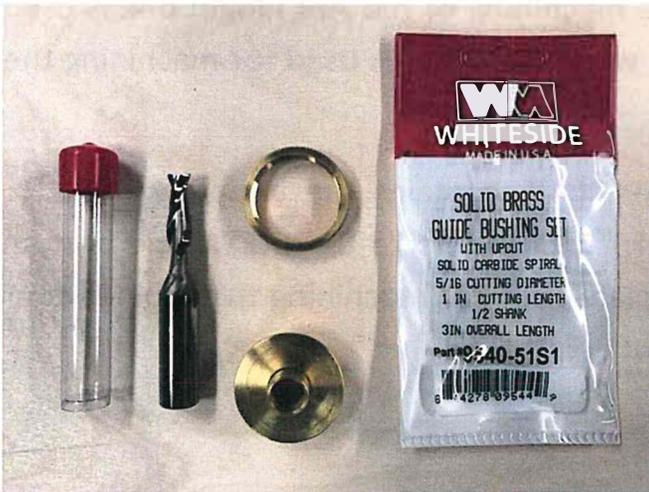
Mèche de toupie à spirale montante Whiteside, dia. 5/16" et bague de guidage en laiton 1/2" dia.
