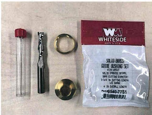
Mèche de toupie à spirale montante Whiteside, dia. 10 mm et bague de guidage en laiton 3/4" dia.
