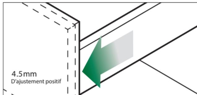
Ajustez simultanément le côté gauche et le côté droit dans des directions opposées.
