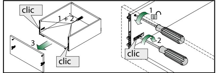
Réglage en hauteur par excentrique (+ 2 / - 1 mm)
