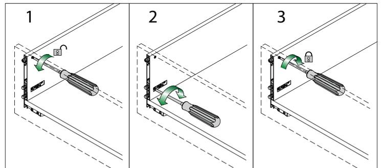
Réglage de l'inclinaison de la façade (+ 2.5 / -1.5 mm)
