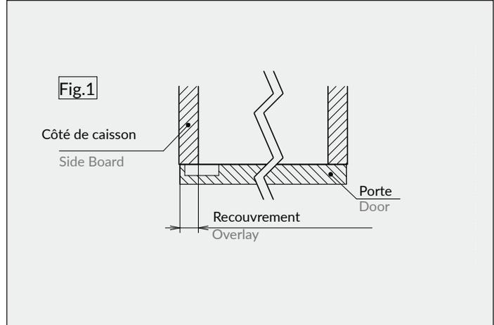
Le recouvrement du côté dans la fig. 1 est de 19 mm avec la plaque incluse. Un écart de 2 mm est requis sur les deux côtés de la porte.
